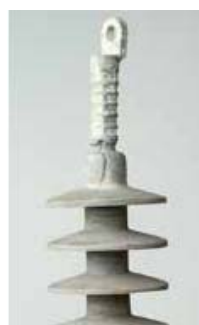
Vzorka poškodená eróziou
