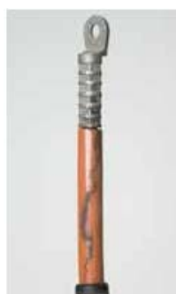
Vzorka poškodená zvodovým prúdom
