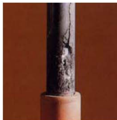
Povrch PE materiálu (čierny) po 48 hodinovej skúške
